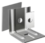
Крепежные кронштейны КК-50 (90, 120, 150, 180 и 230), с шайбой и изоляционной прокладкой, t=1.2 и 2.0 мм
